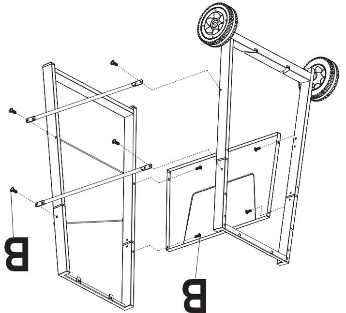
**5** Fixer les front panel et barre de supports arrière du chariot
