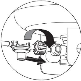
2. Branchez le régulateur et son tuyau sur la bouteille en tournant dans le sens des aiguilles d'une montre jusqu'au blocage.
