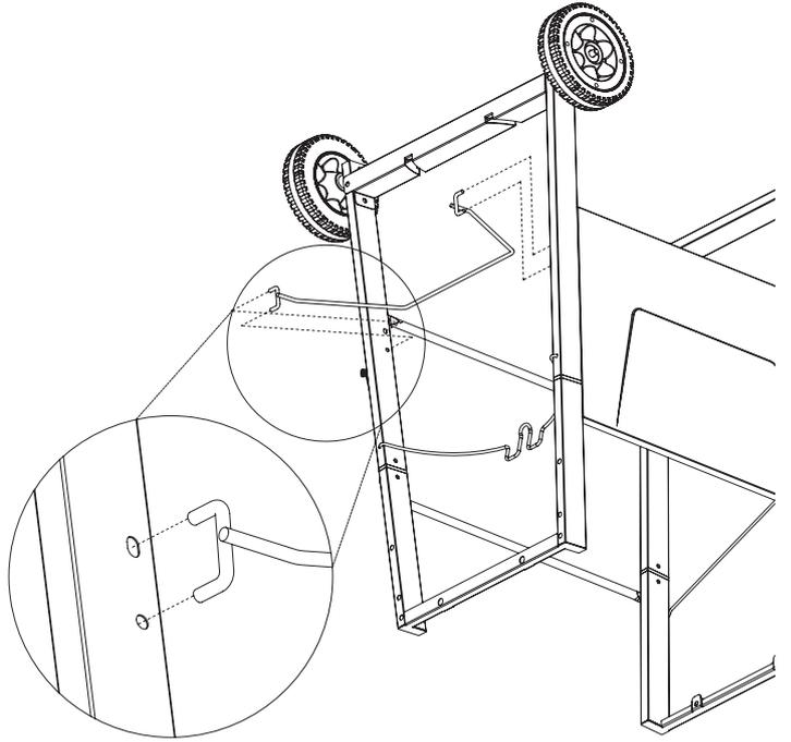
**7** Fixer le fil de bloc de réservoir de gaz LP
